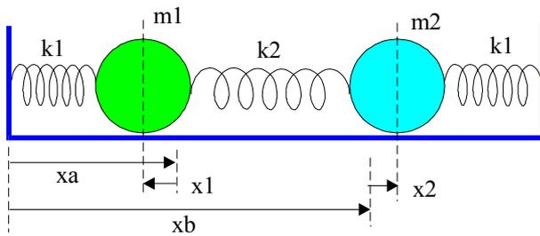
O mais simples dos sistemas acoplado é formado por duas massas  $m_1$  e  $m_2$ , podendo deslizar sem atrito num plano horizontal, e por duas molas de elasticidade  $k_1$ . As duas massas são igualmente ligadas por uma mola com elasticidade  $k_2$ .
