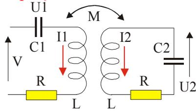
Considerem-se dois circuitos R, L, C em série, associados por indução mútua. As duas indutâncias são idênticas, bem como as resistências. O circuito da esquerda é excitado por uma tensão  $v(t)$  sinusoidal. Estuda-se a corrente em cada circuito.
