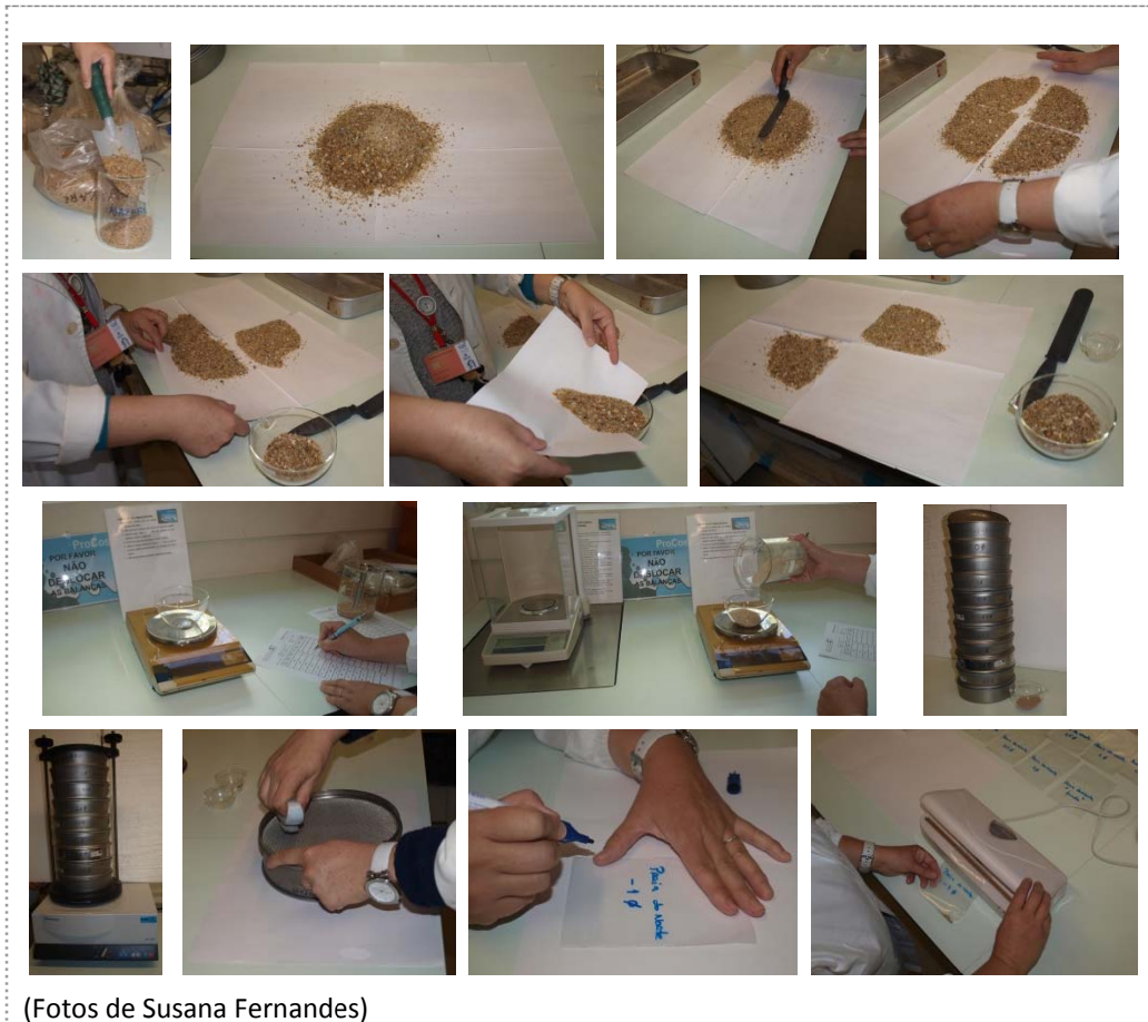
Figura 3 - Sequência fotográfica do protocolo da granulometria de areias.
