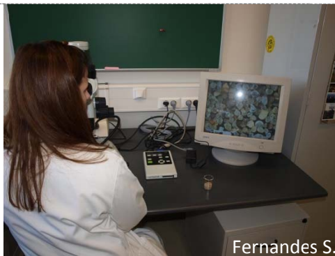
Figura 4 - Lupa binocular com máquina fotográfica incorporada.
