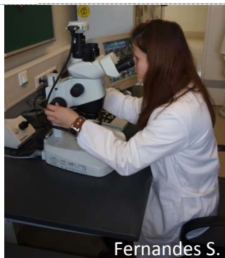
Figura 4 - Lupa binocular com máquina fotográfica incorporada.
